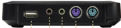
USB連接頭 麥克風連接頭 音源連接頭 PS2滑鼠連接頭 PS2鍵盤連接頭
